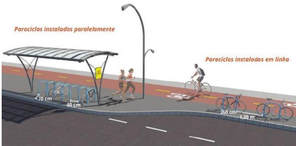
Figura 21. Indicação de dimensões e disposição para instalação de paraciclos.
